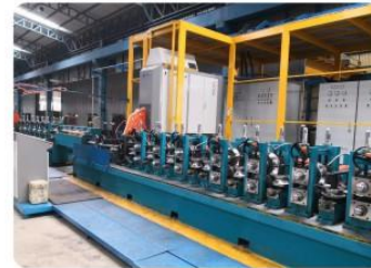
Steel Conduit Line
